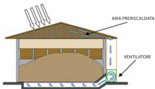
Figura 4.9.2 Sistema di ventilazione forzata con aria preriscaldata nella piattaforma di Pöstal, Stiria – Austria
